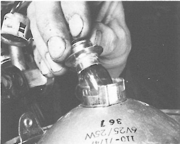
Bild 231 Lasche am Sockel der Glühlampe sorgt für richtige Einbaulage
