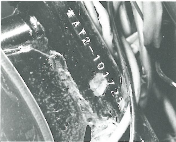
Bild 1 Anbringung der Fahrgestellnummer
