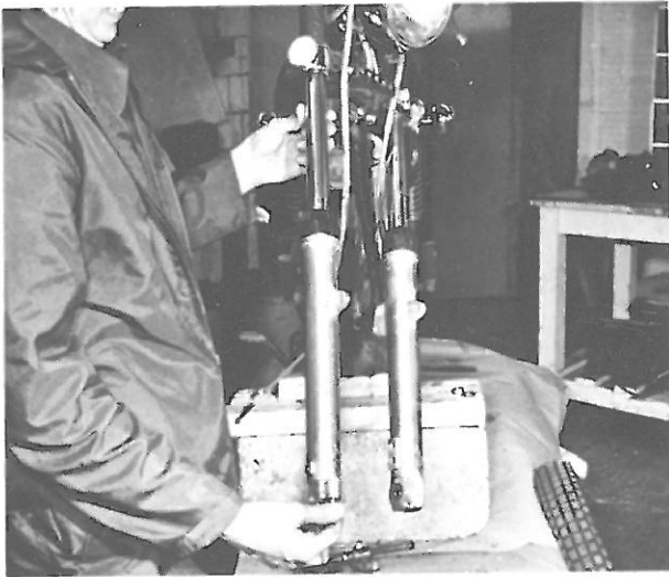
Bild 180 Gabelrohr aus der Gabelbrücke nach unten ziehen
