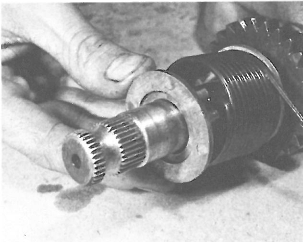
Bild 71 Deckel zur Kickstarterfeder abnehmen
