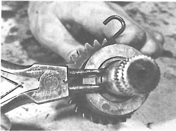
Bild 70 Sicherung am verzahnten Ende der Kickstarterwelle entfernen
