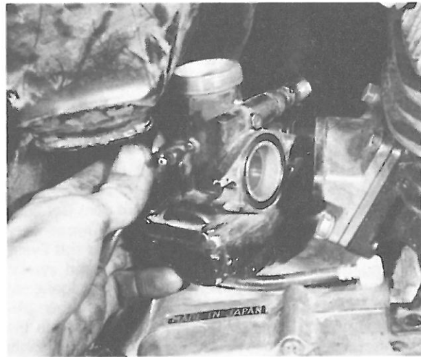
Bild 20 Beachten Sie diese wichtige O-Ring-Abdichtung
