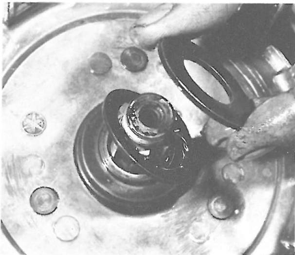
Bild 49 Dreiteiliges Drucklager unter der Kupplungsnahe abnehmen
