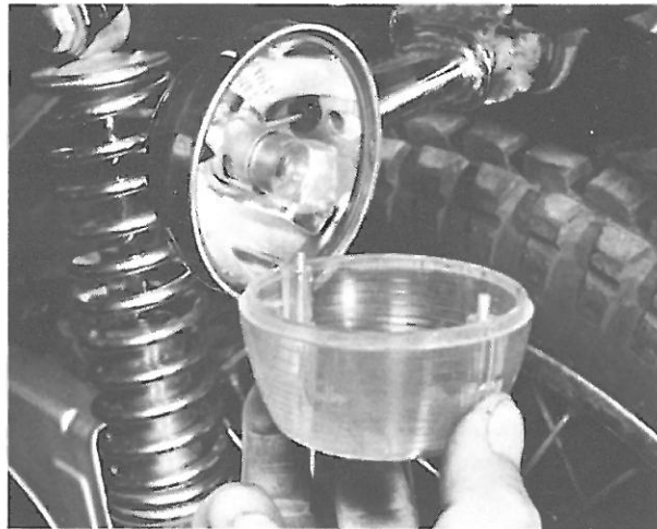
Bild 235 Zwei Schrauben halten die Blinkleuchtengehäuse
