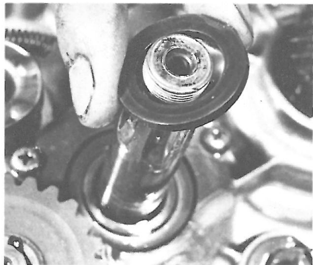
Bild 94 Anlaufscheibe auf Getriebehauptwelle aufstecken
