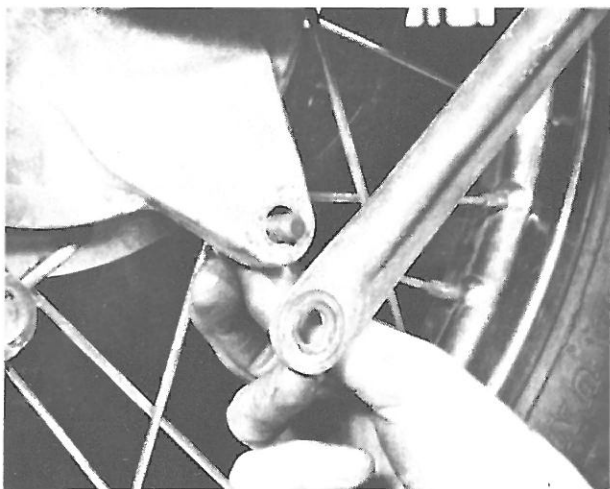
Bild 196 Bremsstützstrebe an der Ankerplatte losschrauben
