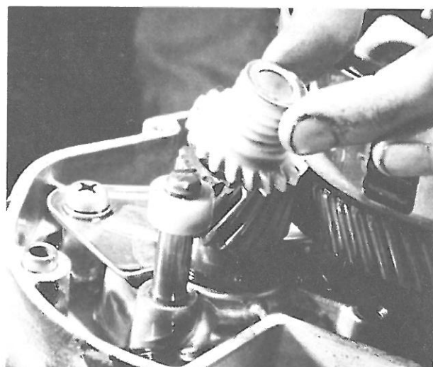
Bild 112 Distanzbüchse und Drehzahlmesserantriebsrad sind aus Kunststoff
