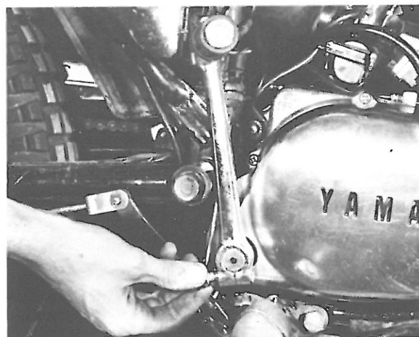
Bild 205 Kickstarterhebel ist mit Klemmschraube auf Zahnprofil befestigt
