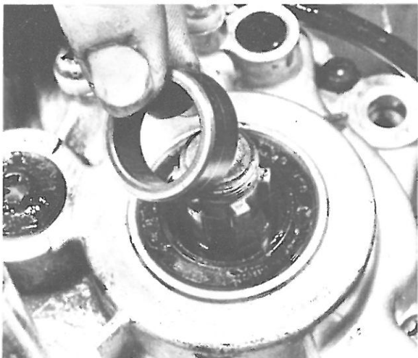
Bild 40 Abstandshülse zum Kettenrad abziehen
