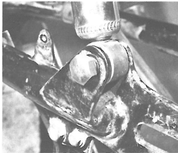
Bild 198 Verchromte Schraube ohne Mutter zur Federbeinbefestigung
