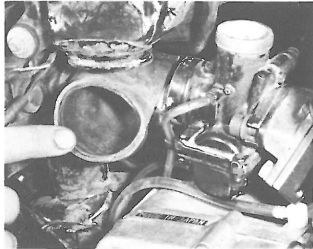
Bild 140 Schlauchstützen ist am Luftfilter mit Federklip befestigt
