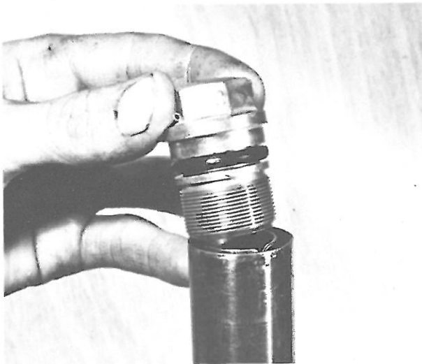
Bild 182 Verchromte Hohl-schraube am Kopf des Gabelrohrs entfernen
