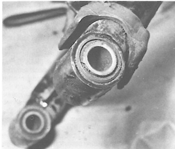
Bild 201 Die Führungsbüchsen sind einteilige Gummielemente (Silent-bloc)
