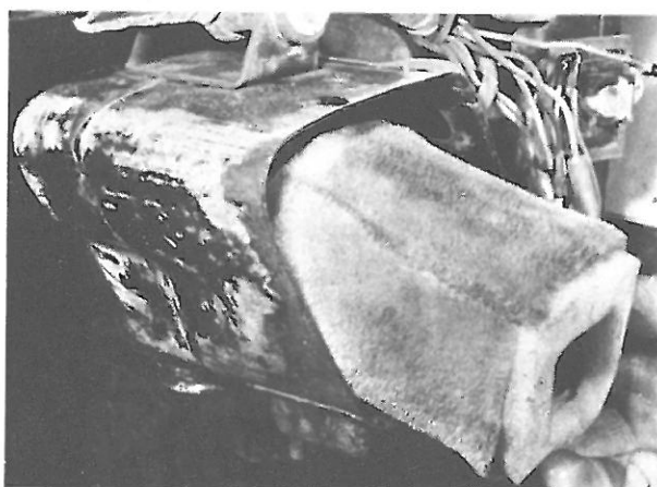
Bild 153 Filtereinsatz wird zum Reinigen herausgenommen
