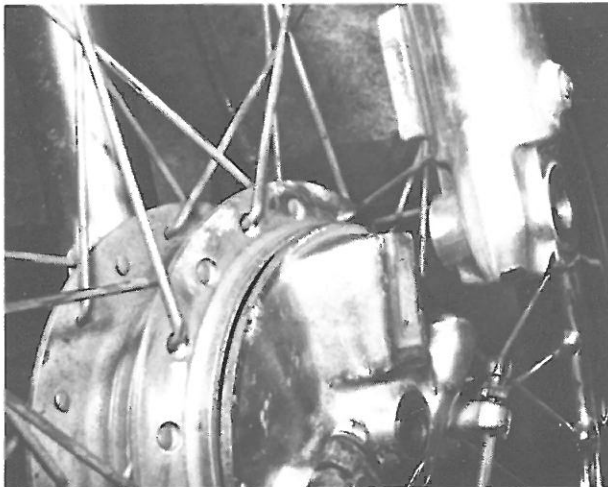
Bild 193 Führungssteg am linken Gabelrohr greift in Bremsankerplatte
