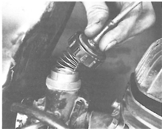
Bild 141 Gerändelte Verschraubung lösen, um Gasschieber auszubauen
