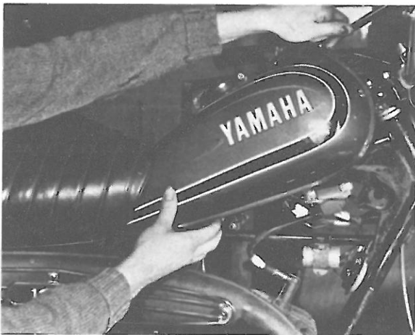
Bild 5 Tank zurückziehen, dann nach oben abnehmen
