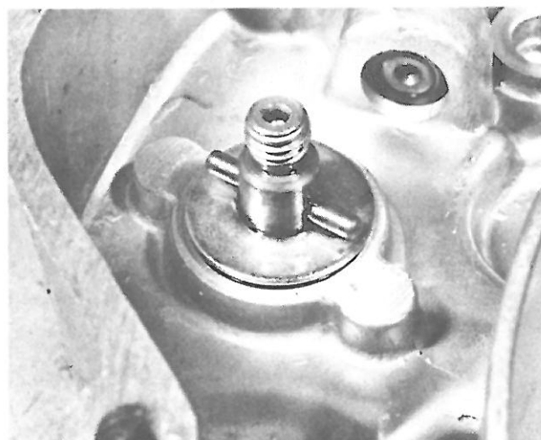
Bild 69 Mitnehmerstift in der Welle des Ölpumpenantriebs
