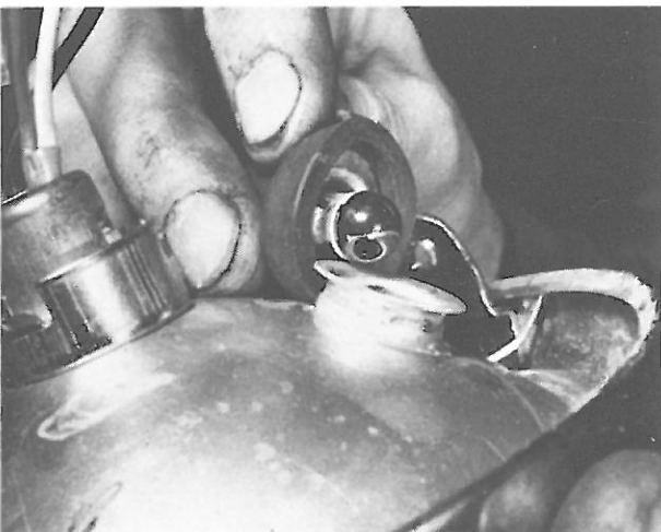
Bild 232 Standlichtlampe mit Bajonettfassung
