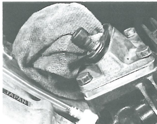
Bild 150 Saugventil und Zwischenflansch mit vier Schrauben und Scheiben montiert
