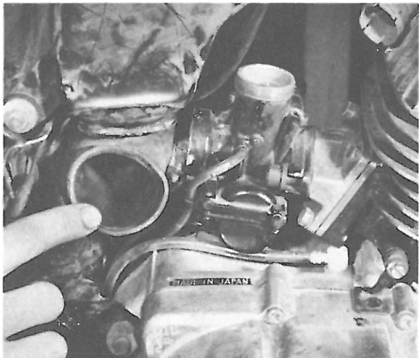
Bild 18 Schlauchstutzen zum Luftfilter mit Federklip und geschraubtem Schlauchbinder befestigt
