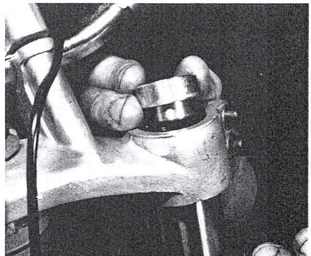
Bild 138 An einigen Modellen sitzt am oberen Standrohrende eine abgesetzte Distanzbüchse
