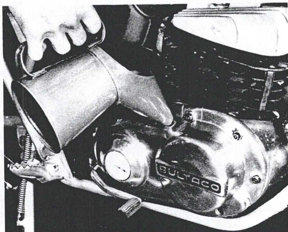
Bild 5 Füllen des Primärtriebsgehäuses
