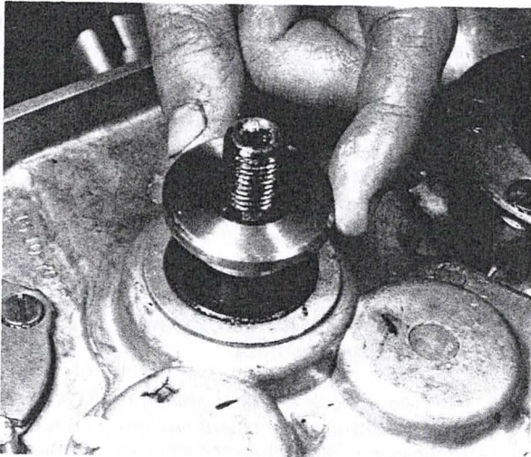
Bild 76 Aufsetzen der Distanzscheibe auf die Hauptwelle
